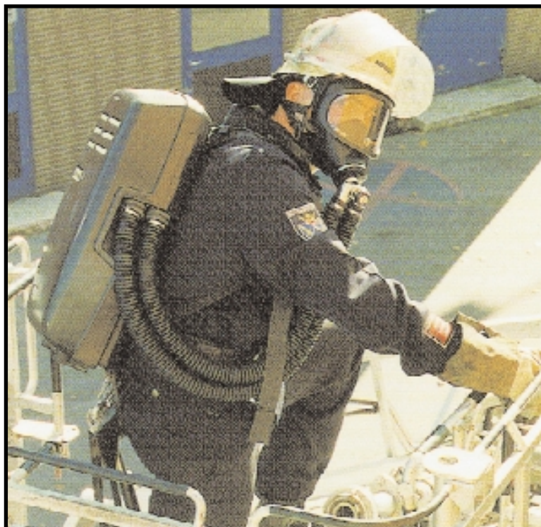
Equipo de circuito cerrado de oxígeno químico
