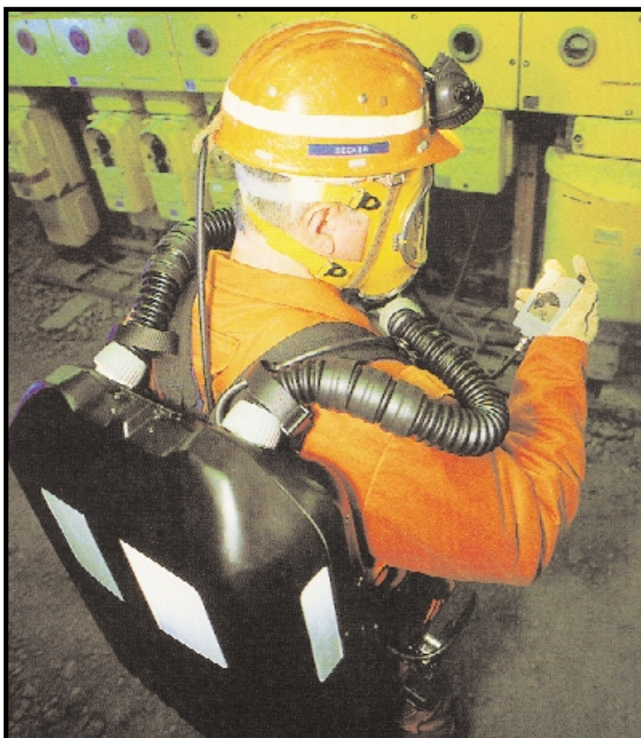
Equipo de circuito cerrado de oxígeno presurizado.
